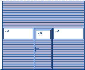
Sekční vrat SPU F42 s integrovanými dveřmi bez vysokého prahu
