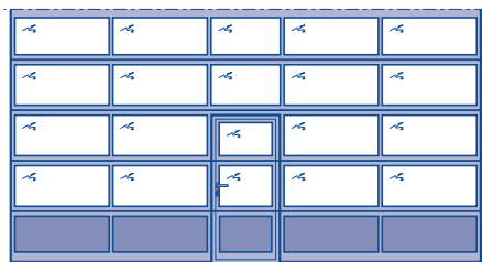
Sekční vrata ALR F42 s integrovanými dveřmi bez vysokého prahu
