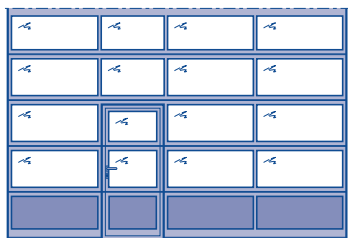
Sekční vrata ALR F42 s integrovanými dveřmi bez vysokého prahu
